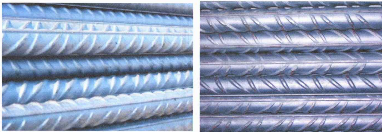
a) b) Fig. 1 - Oțel beton B500B (a) și B500C (b)
