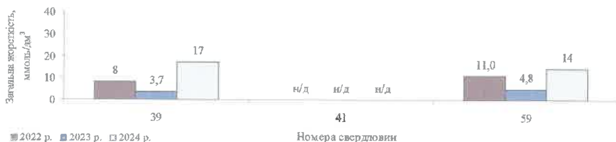
Рис. 36 Діаграми зміни мінералізації, вмісту хлор-іону, сульфат-іону, загальної жорсткості в багаторічному розрізі у підземних водах водоносного горизонту неогенових відкладів по відомчій мережі свердловин, розташованих на полігоні для захоронення промислових та будівельних відходів
