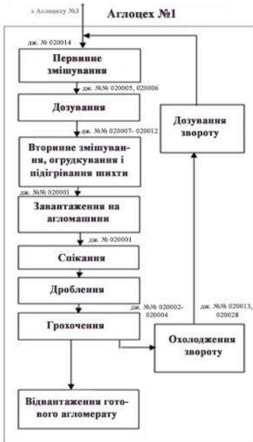
Рис.2.16.2. Блок-схема виробництва агломерату на аглофабриці (АЦ-1)
